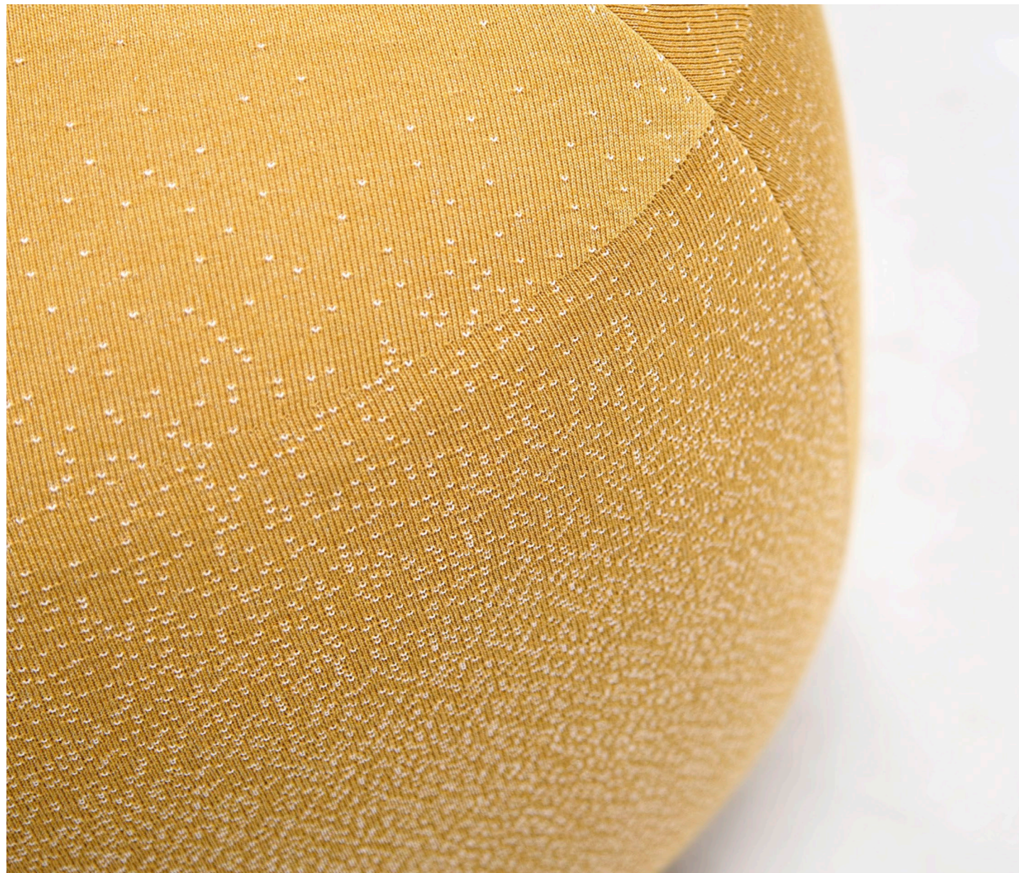
ShapeKnit tekstilløsningerne kan fremstilles i ét stykke, og er klar til øjeblikkelig brug uden yderligere tilpasning, tilskæring eller syning.
